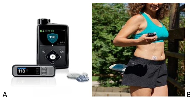
Figure 1 : système MiniMed 670G de MEDTRONIC / A : les différents composants du système ; B : port du système en pratique.
